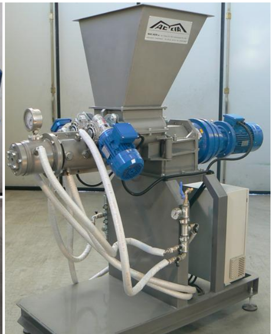
Estrusore per gesso con impianto di raffreddamento integrato
