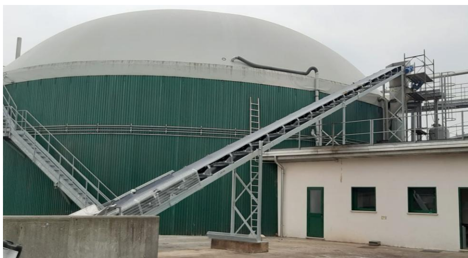
Nastri TNV con tappeto in gomma customizzati per l'alimentazione materie prime per impianti Biogas/Biometano
