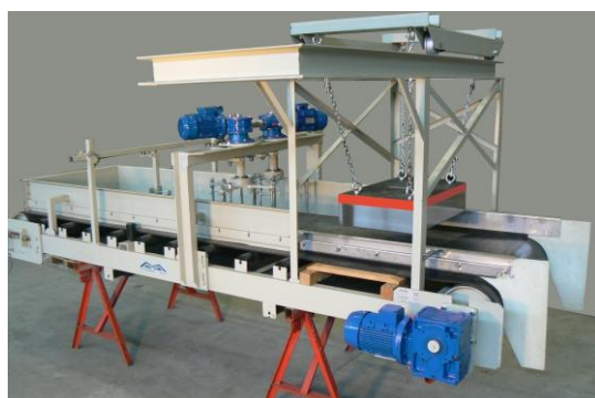
Sistema di alimentazione laminatoio con magnete e doppio livellatore
