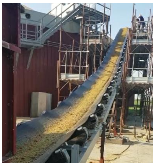
Nastri TNV con tappeto in gomma customizzati per l'alimentazione materie prime per impianti Biogas/Biometano
