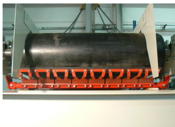
Esempio di raschietto con precarica e con punti di contatto in Widia
